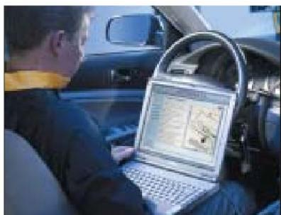
В зависимости от типа автомобиля и прибора для диагностики можно выявить неисправность в системе зажигания.
