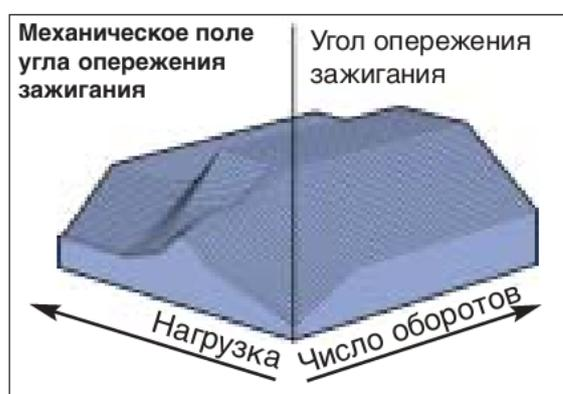
Сигнал вакуумного сенсорного датчика используется для зажигания как сигнал нагрузки. На основании этого сигнала происходит построение объёмного поля угла опережения зажигания. Это поле позволяет запрограммировать для каждого числа оборотов и нагрузки наиболее выгодный угол опережения зажигания. В каждом поле предусмотрено до 4000 различных значений угла опережения зажигания. То есть существуют различные графики для определённых режимов
